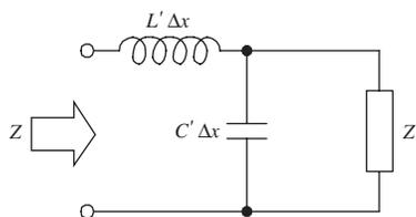
$$Z = j\omega L'\Delta x + \frac{Z/j\omega C'\Delta x}{Z + 1/j\omega C'\Delta x} = j\omega L'\Delta x + \frac{Z}{1 + j\omega C'Z\Delta x}$$
