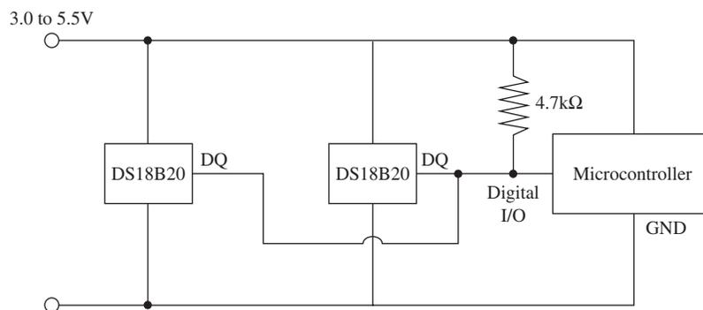
FIGURE 6.9 DS18B20 temperature sensor IC.
